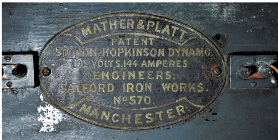
愛迪生—霍普金森式直流發電機 (The Edison-Hopkinson Dynamo)
